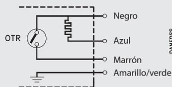
OTR: termostato en precalentador de gasóleo
